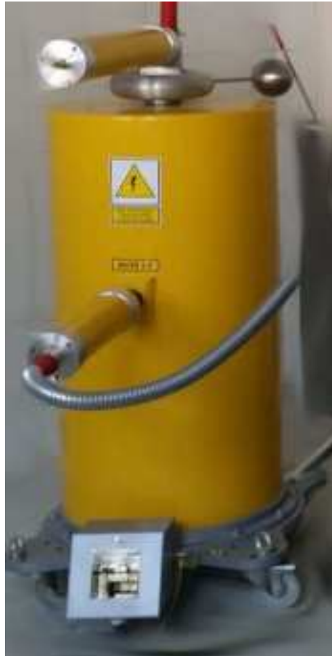
Rys. 1. Zestaw rezystorów tłumiących zainstalowanych na transformatorze probierczym ZTP
