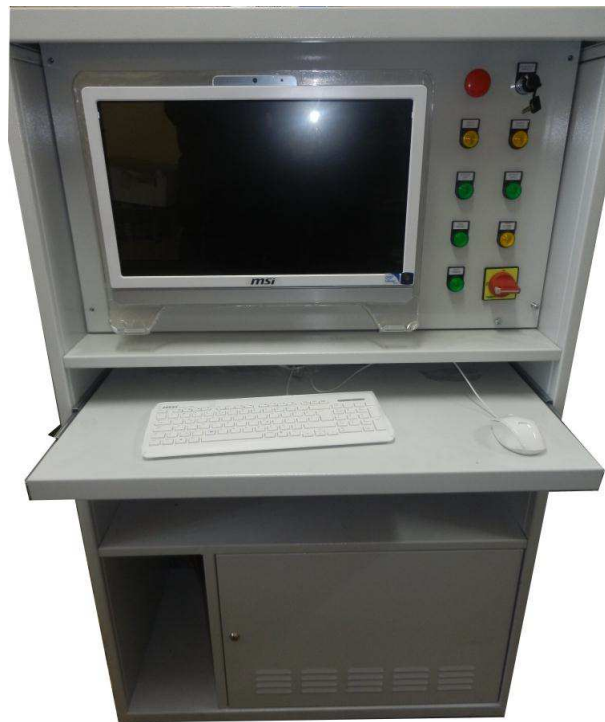
Rys. 1. Pulpit sterowania układami wysokiego napięcia.
