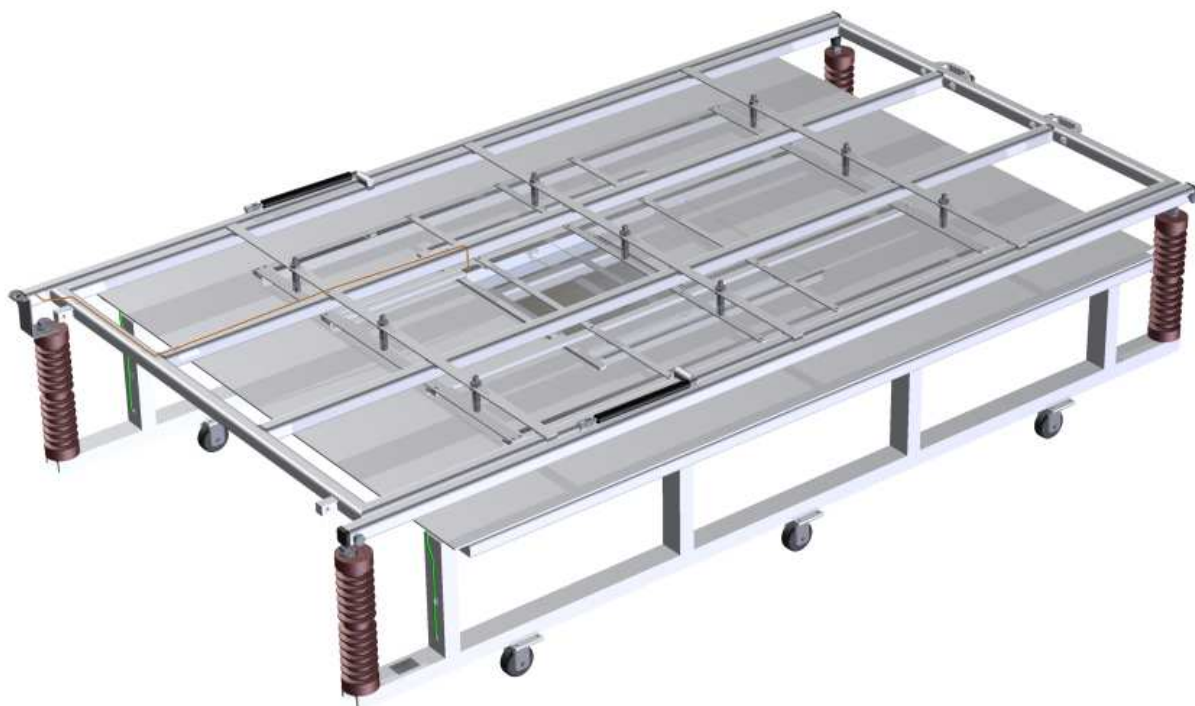
Rys.1. Urządzenie do badań mat i dywanów elektroizolacyjnych UCI-40-10
