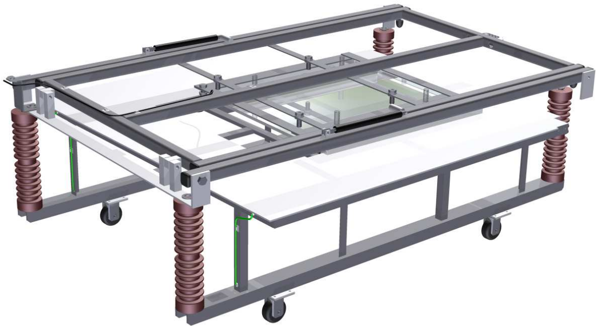
Rys.1. Urządzenie do badań mat i dywanów elektroizolacyjnych UCI-40-07
